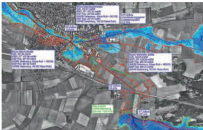
Simulierte Wirkung des Bauwerks bei HQ100 aus dem Jahr 2017
