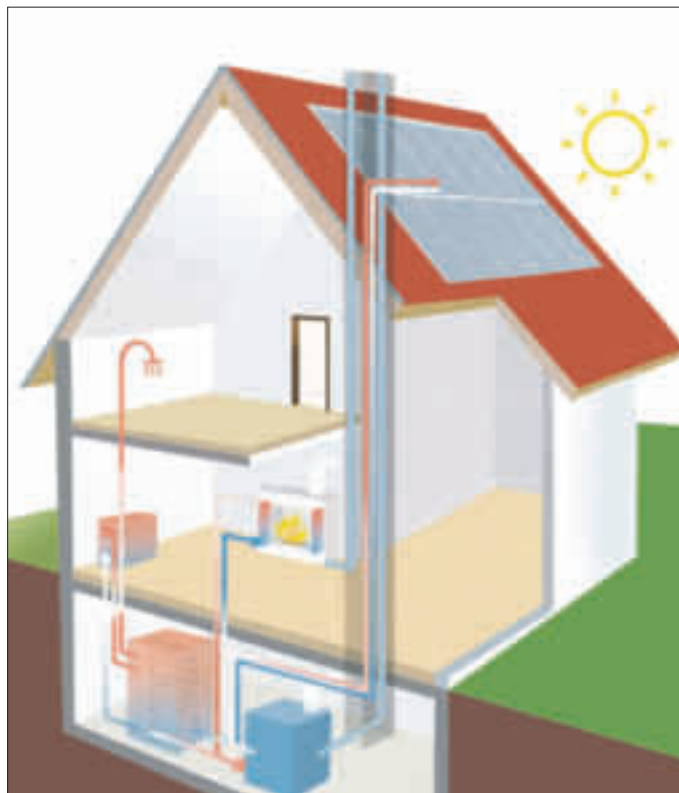
Ein Kamin- oder Kachelofen mit Wassertasche kombiniert mit einer Solarthermieanlage kann den niedrigen Heizwärmebedarf moderner Neubauten optimal unterstützen. Grafik: Erlus/InterPress
