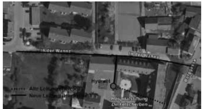
Dies dient zum einen der Versorgungsredundanz im Falle von Rohrbrüchen und zum anderen wird eine der letzten bekannten Totleitungen eliminiert. Diese führt heute von der Burggasse durch den Keller des Hospitals zu einem Löschwasserhydranten im Spitalinnenhof.
