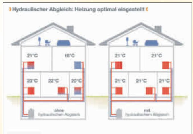
Gewusst wie: Der hydraulische Abgleich sorgt für eine gleichmäßige und effiziente Wärmeverteilung. Grafik: IWO/interPress
